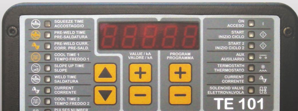
**TE101** es un control de soldadura a microprocesador para máquinas monofásicas de soldadura por resistencia. Gracias a su versatilidad puede ser utilizado en una vasta gama de aplicaciones, de las máquinas manuales (asi sean con accionamiento manual o neumático) como en los equipos de soldadura automatizados. El amperímetro integrado y la función de límites de control de la corriente de soldadura, permiten una regulación más fácil y al mismo tiempo el control de la calidad de las soldaduras.
